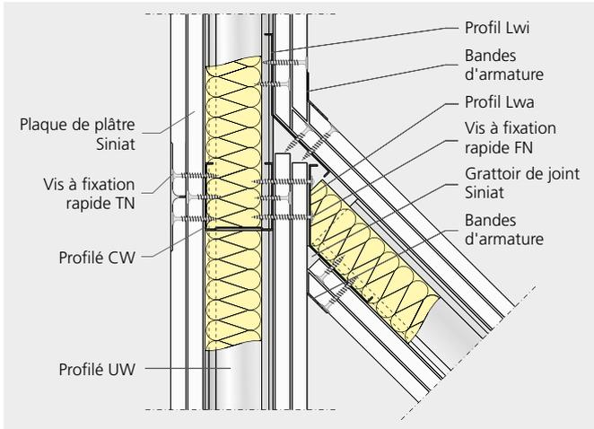
SW12 Assemblage en T en équerre avec profil mural d'angle intérieur en L Profil mural d'angle extérieur en L et (LWi)
