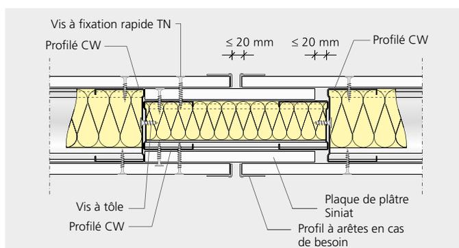
SW11 Joint de fractionnement avec parement monocouche
