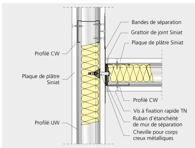
SW11 Assemblage en T avec parement continu
