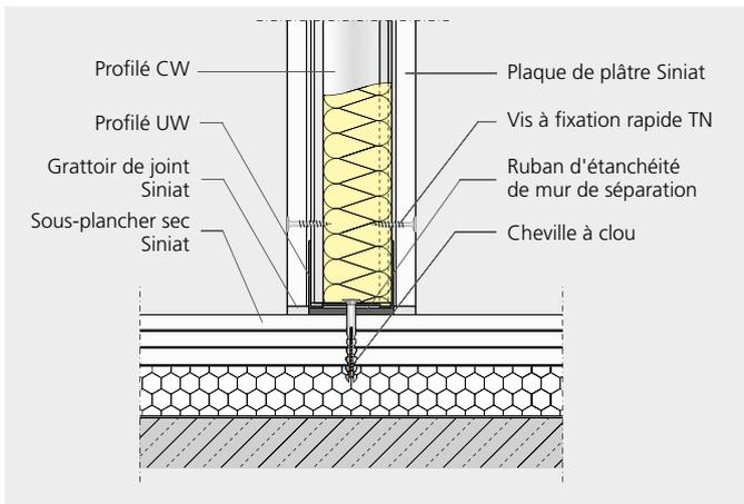
**SW11** Raccord au sous-plancher sec
