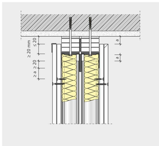
SW13 Raccord coulissant pour plafond avec exigence de protection pare-feu, recouvrement et début de profil
