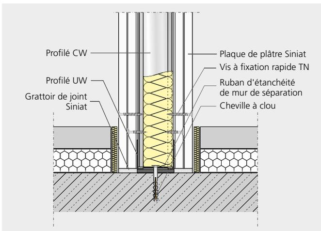
SW12 Raccord sur plafond massif ; chape dans la zone du mur évidée
