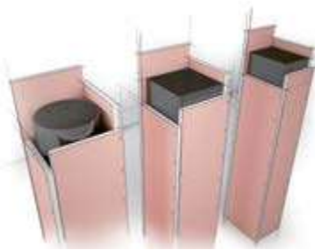
Geschlossene Stahlhohlprofile 4-seitig Brandschutz bis 180 Minuten Feuer- widerstand
