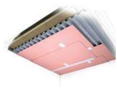
Bekleidung von Trapezblechdächern Brandschutz bis 90 Minuten Feuerwiderstand
