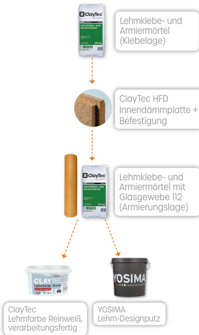
\* Zur Befestigung bietet ClayTec Schrauben für Holzbalken und Schraubdübel für mineralische Untergründe an. Der Bedarf liegt bei 6-8 Stück/m<sup>2</sup>. Es ist zu empfehlen, auf der Baustelle unterschiedliche Längen verfügbar zu haben. Durch ausreichend tiefe Befestigung wird sichergestellt, dass die Platten mit gesamter Fläche in das Klebebett gedrückt werden. Die Anpressteller sind für Schrauben und Schraubdübel gleich geeignet.
