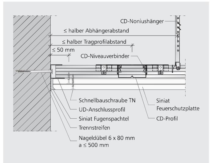
**SD51 SU WA16** – Anschluss an Massivwand; Grundprofil quer; U-Anschlussprofil
