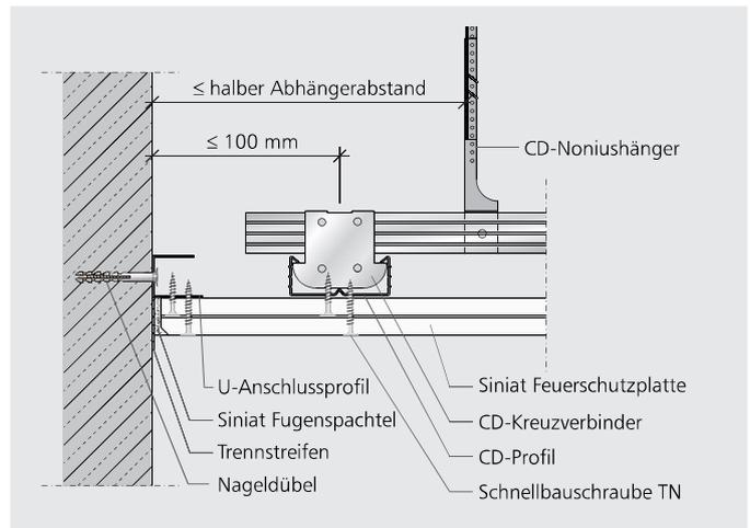
SD51 SU WA03 – Anschluss an Massivwand; Beplankung im Anschlussprofil verschraubt
