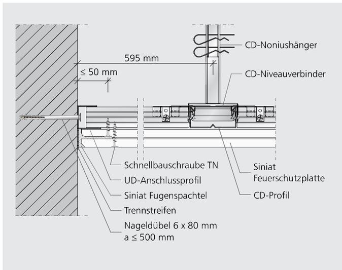
**SD51 SU WA15** – Anschluss an Massivwand; Tragprofil quer; U-Anschlussprofil
