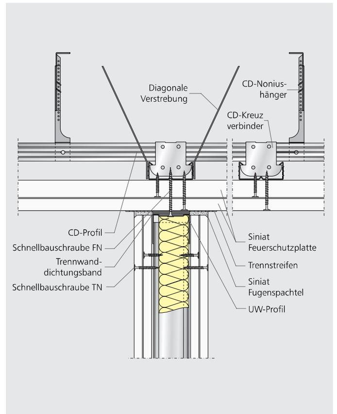
SD51 SU UD02 – Anschluss einer Metallständerwand bei durchgehender Beplankung
