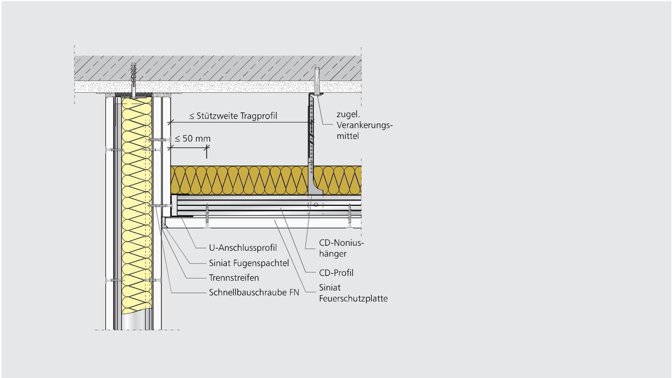
SD51 SU WA09 – Anschluss an Metallständerwand F 30-A mit Aufdopplung im Zwischendeckenbereich
