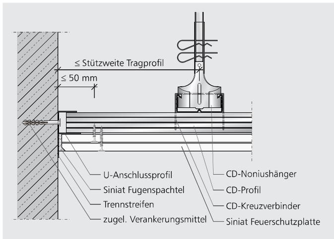
SD51 SU WA01 – Anschluss an Massivwand; Tragprofil quer; U-Anschlussprofil
