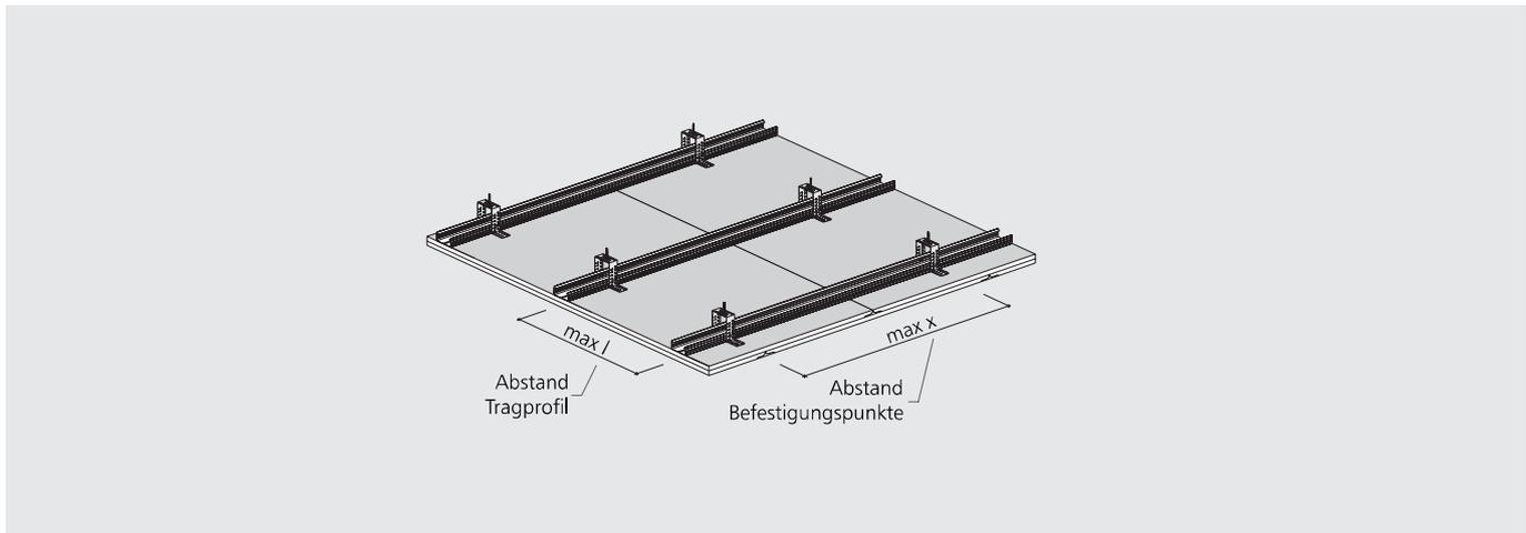
SD52 SB DBP01 – Deckenbekleidung mit Siniat Gipsplatten auf Metall-Unterkonstruktion
