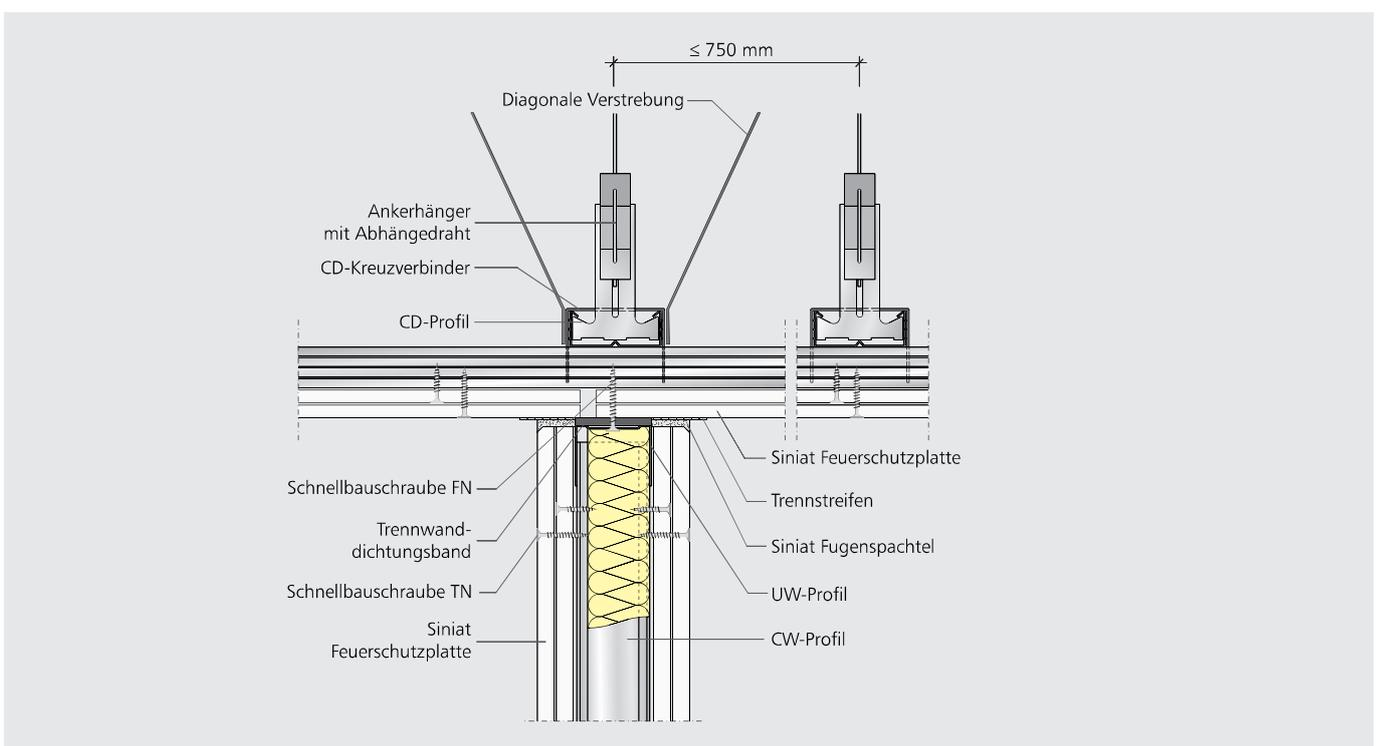
SD51 SU UD01 – Anschluss einer Metallständerwand bei unterbrochener Beplankung, Brandbeanspruchung von unten
