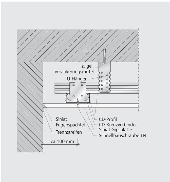
**SD50 DB WA03** – Starrer Anschluss an Massivwand mit Trennstreifen ohne Profilhinterlegung
