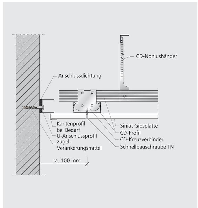
**SD50 UD WA06** – Gleitender Anschluss an Massivwand mit sichtbarem Anschlussprofil bei horizontaler Gleitung
