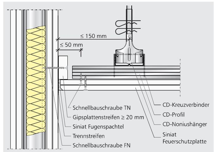
SD51 SU WA04 – Anschluss an Metallständerwand mit Plattenstreifen hinterlegt; Breite ≥ 80 mm
