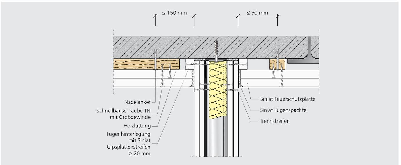
SD52 SB WA02 – Wand- und Deckenanschluss an Massivdecke, Traglatten ≥ 50 x 30 mm; quer und längs mit Hinterlegung
