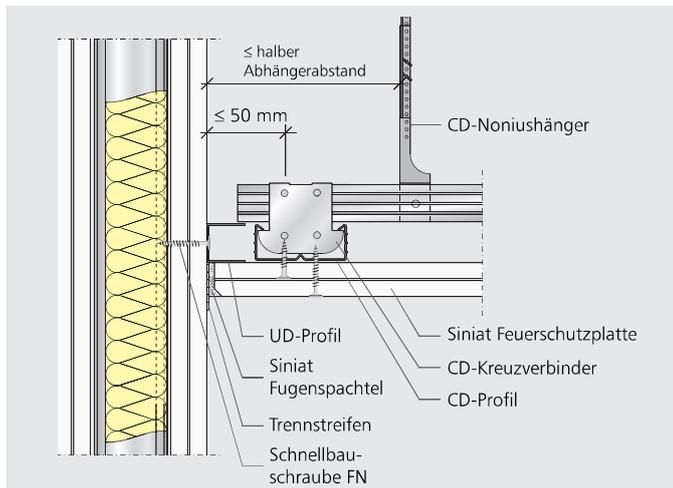
SD51 SU WA02 – Anschluss an Metallständerwand; Tragprofil längs
