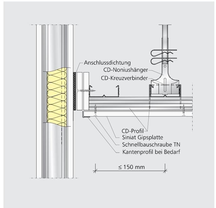
**SD50 UD WA07** – Gleitender Anschluss an Metallständerwand bei vertikaler Gleitung (Deckendurchbiegung)
