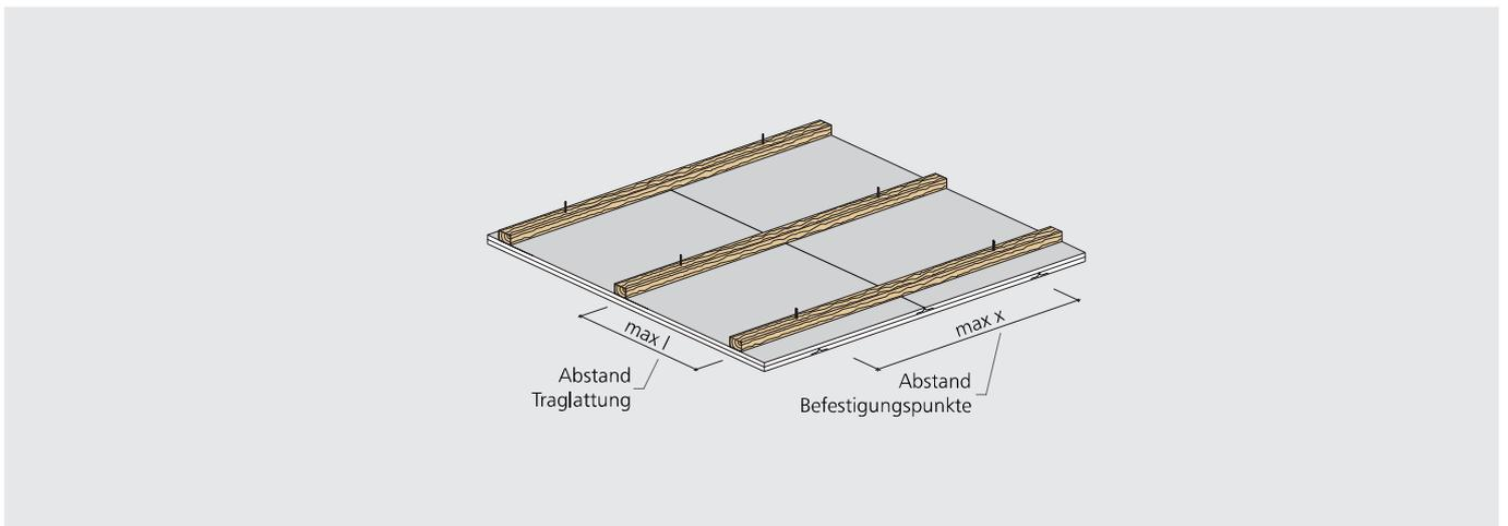
SD52 SB DBP04 – Deckenbekleidung mit Siniat Gipsplatten auf Holz-Unterkonstruktion
