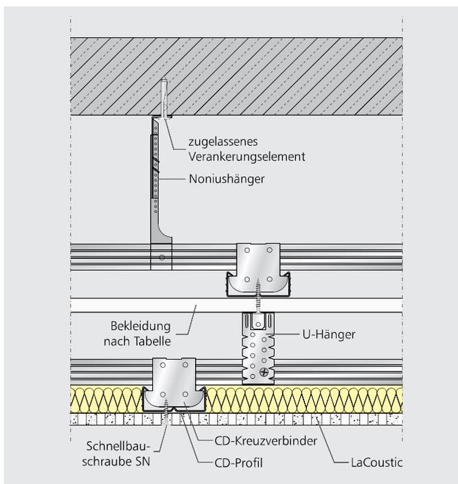
SD51 UD SD01 – Unterdecke mit abgehängter Sichtdecke LaCoustic
