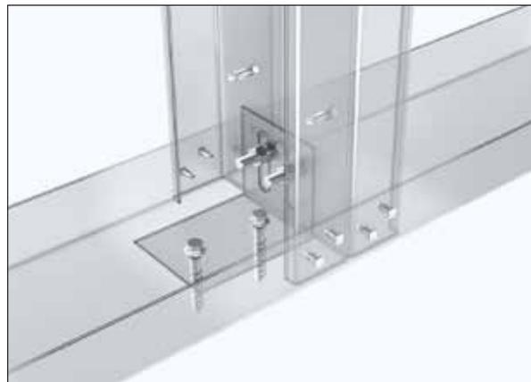
Bodenanschluss mit Verstärkung für Öffnung
